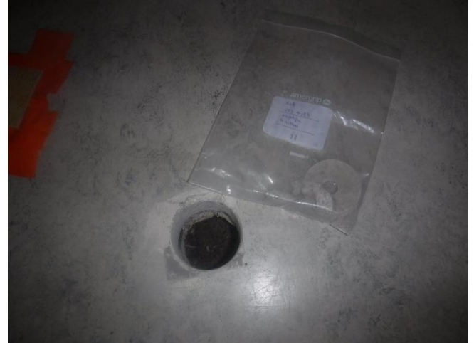
Kuva 10. Koontinäytteenä kerätty vaalea linoleumimatto, liima ja alapohjan tasoitteet eivät sisällä asbestia (ASB2)
