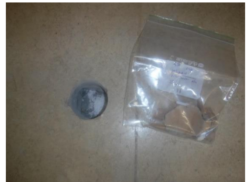
Kuva 28. Tilan 048 alapohjan valupaperi betoni-laatan alla ei sisällä asbestia (ASB20)
