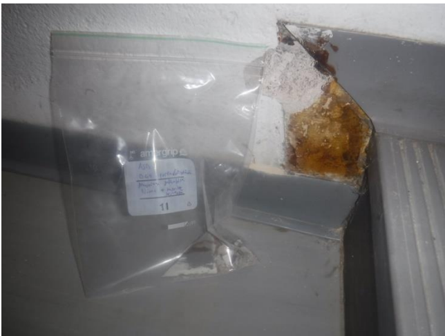
Kuva 15. Porraskäytävän 044 muovinen jalkalista, kiinnitysliima sekä seinätasoite eivät sisällä asbestia (ASB7)
