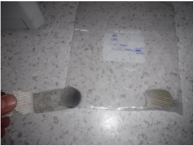
Kuva 11. Tilan 193 välikohjan muovimaton kiinnitysliima ja tasoitteet eivät sisällä asbestia (ASB3)
