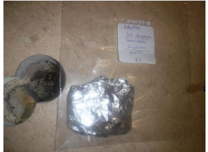
Kuva 22. Tilan 115 alapohjan bitumisively pohjalaatan päällä ei si- sällä asbestia (ASB14)
