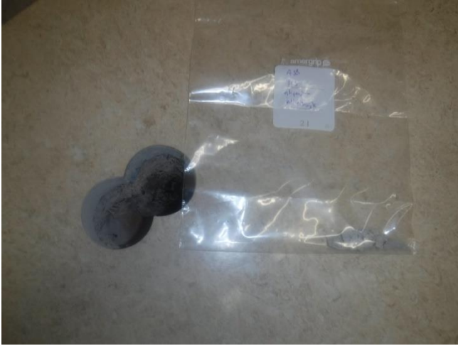
Kuva 13. Koontinäytteenä tiloista 115 ja 134 kerätty alapohjan lattiatasoitenäyte ei sisällä asbestia (ASB5)
