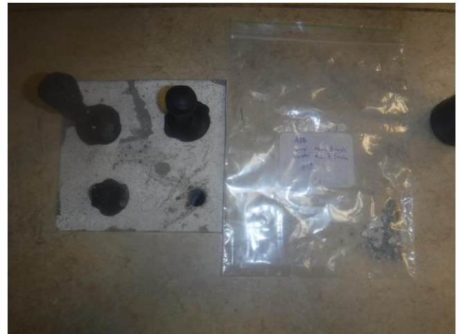
Kuva 12. Tilojen 045 ja 048 alapohjan vaalea linoleumimatto, kiinnitysliima ja tasoitteet eivät sisällä asbestia (ASB4)
