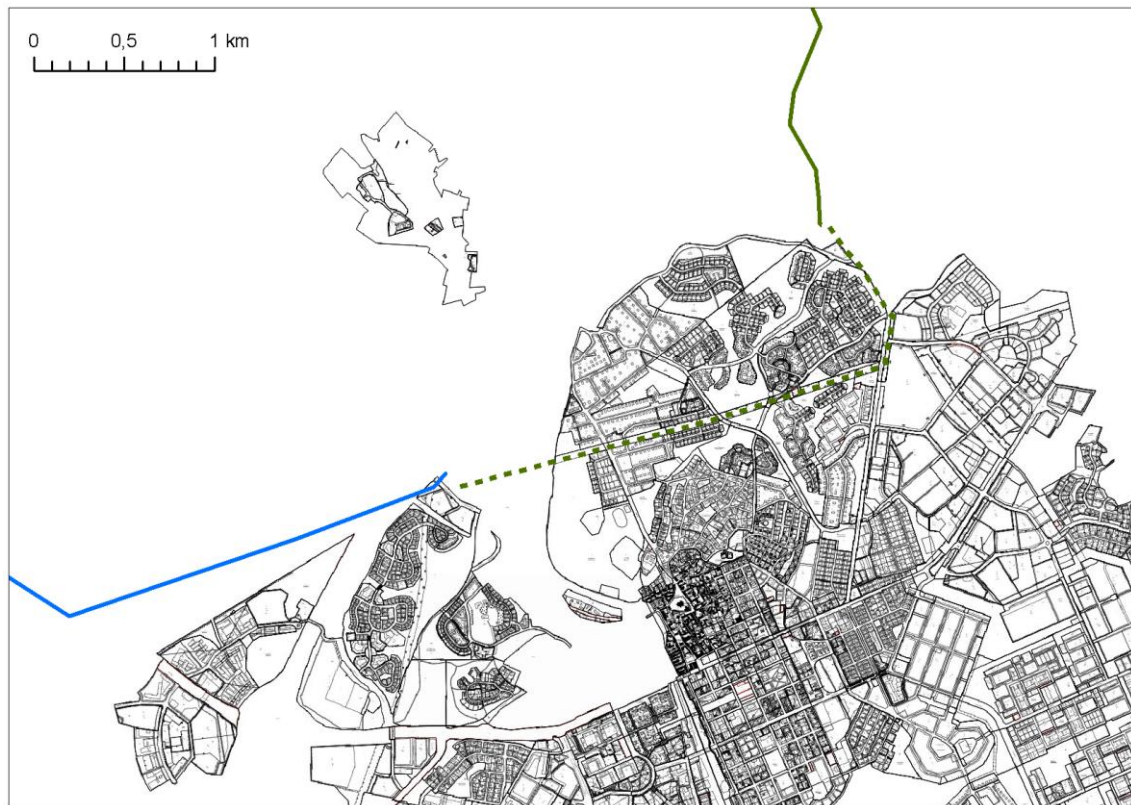
Kuva 3-13. Ote Porvoon ajantasa-asemakaavasta. Voimajohtoreitti 1 on lisätty otteeseen vihreällä viivalla ja katkoviivalla ja voimajohtoreitti 2 sinisellä viivalla.
